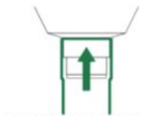
INNESTO TUBO PLUVIALE MASCHIO - FEMMINA
